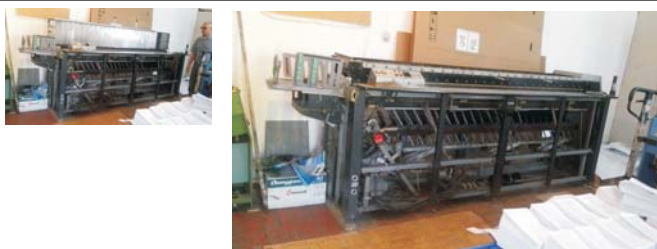
Листоподборка горизонтальная, фрикционная на 24 секции
